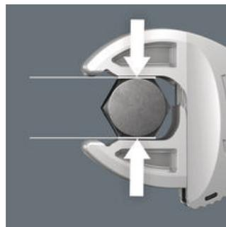
Les mors parallèles lisses du Joker 6004 exercent une pression de surface et empêchent ainsi l'arrondissement de l'écrou ou de la tête de la vis susceptible de se produire lorsque la force est transmise par les angles.
