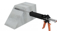
Remplir ainsi 1/2 à 2/3 du trou du fond vers l'extérieur en reculant d'une graduation sur la buse à chaque pompée.
